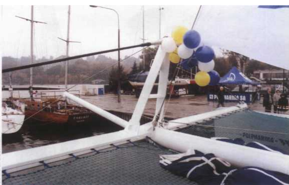
Dziób jachtu. Wszystkie dźwigary wykonane są z aluminium
