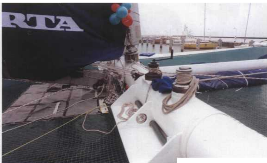
Środkowy dźwigar stanowi podporę dla masztu
