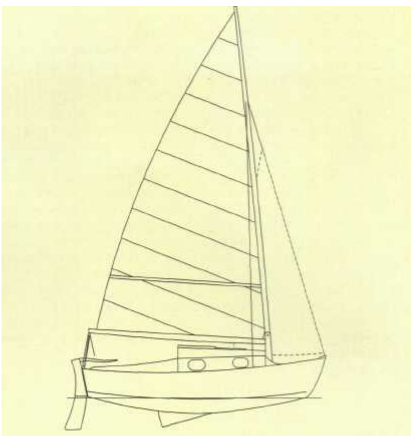
Simple (dł. 4,87 m, szer. 1,98 m, pow. ożagl. 12 m 2 ). Konstrukcja z roku 1965
