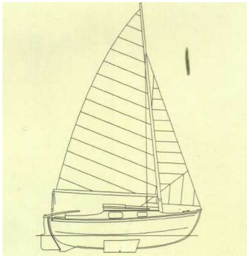
Nord (dł. 5,0 m, szer. 1,8 m, pow. ożagl. 16 m 2 ). Konstrukcja z roku 1967
