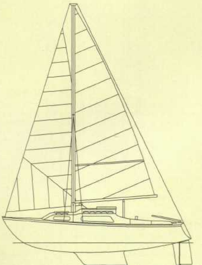
Giga II (dł. 6,45 m, szer. 2,10 m, pow. ożagl. 18,2 m 2 ). Konstrukcja z roku 1971
