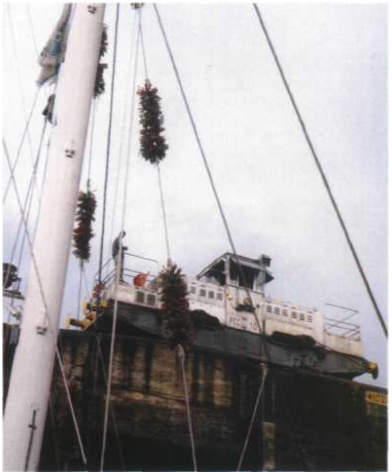
Lokomotywka, zwana mułem, w służbie kanału. Służy do przeciągania wielkich statków
